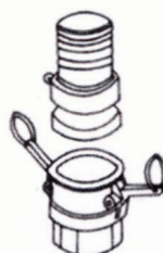
Csatlakozás kapoccsal (polipropilénből vagy rozsdamentes acélból AISI304 és 316L)
